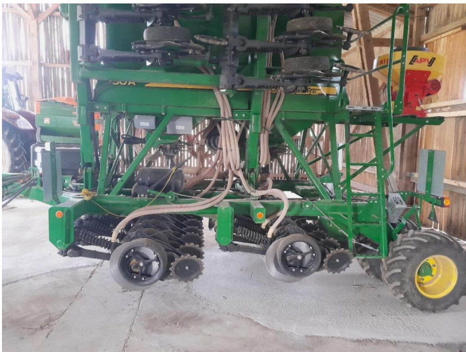
Direktsaat-Maschine John Deere 750 A 6m Arbeitsbreite
