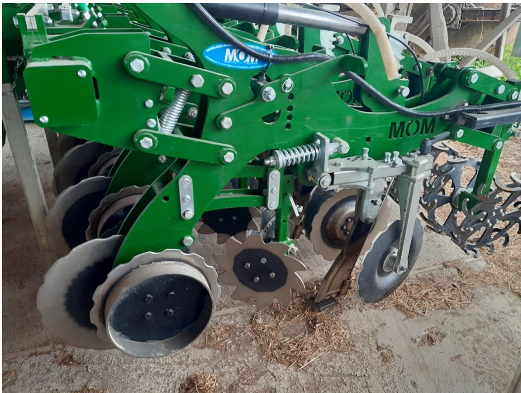
Strip-Till-Gerät, Marke MOM, 6 reihig, Reihenweite 45-75 cm
